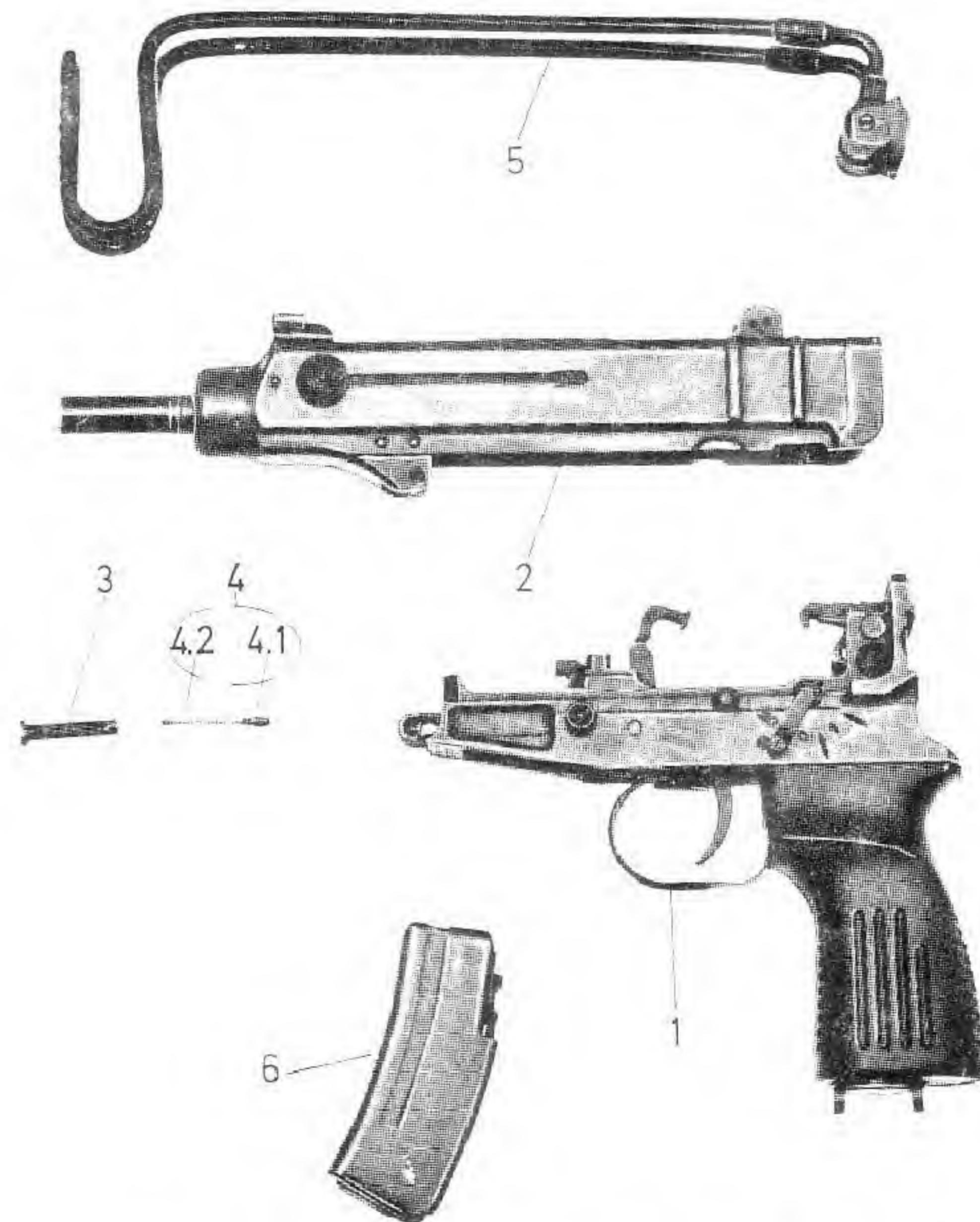
Sl. 4 – **Osnovni sklopovi pištolja 7,65 mm M84:**
